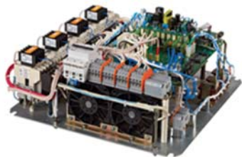
Сборка частотно-регулируемого преобразователя на монтажной панели
