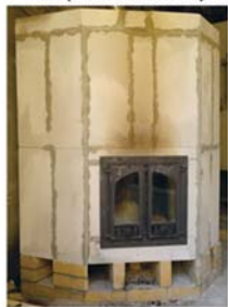
Теплоаккумулятор СТЭ типа «Печь» в собранном виде без внешней отделки и вентиляторов
